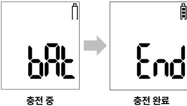
충전용 Adapter 를 기기에 장착 하면 측정 모드 일 경우나 전원이 오프 되어 있는 상태라도 배터리 충전모드 화면이 표시되며 adapter를 제거하면 전원 off 상태가 됩니다.
