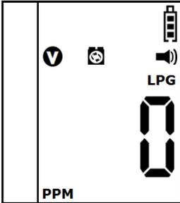
전원을 켜면 LPG/LNG 검지기의 경우, 다음과 같은 가스 측정 모드로 전환됩니다. 측정 모드에서는 가스의 농도, 흡입펌프 상태, 경고음 상태, 배터리 잔량이 LCD에 표시되며 가스의 농도는 가연성 가스는 %LEL, 수소는 ppm 단위로 표기됩니다.
