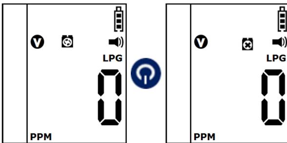
전원을 켜면 흡입펌프가 On 상태로 설정되어 있으며, 이 때 전원 key를 한 번 누르면 흡입펌프가 Off 상태로 변경됩니다. 전원 key를 반복적으로 누르면 흡입 펌프의 On/Off가 반복됩니다.
